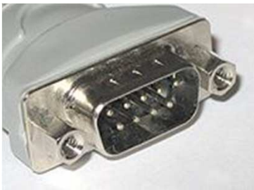
sériový port dříve používaný pro připojení myši
