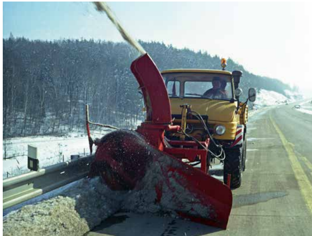
Odstraňování sněhu ze zpevněné krajnice sněhovou frézou S 3 na Unimogu U 80 v km 19,5 vlevo na D 1 dne 21. února 1975
