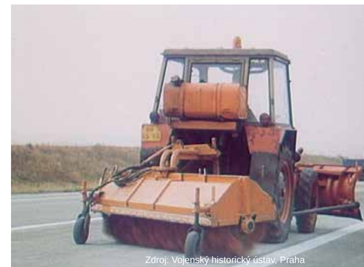
Traktor se zametačem z SSÚD 3 naposledy čistí dráhu před začátkem létání
