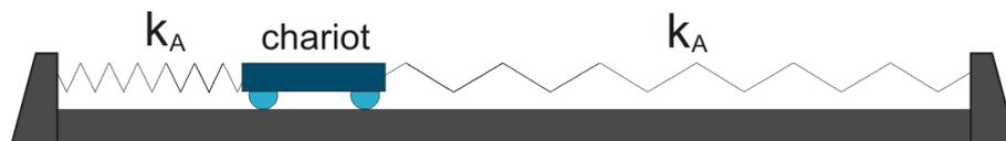
1. Le système peut être symbolisé par un seul ressort horizontal de raideur  $2 \cdot k_A$  avec une masse  $m$  (masse du système) à son extrémité libre. Dessiner le schéma correspondant.
